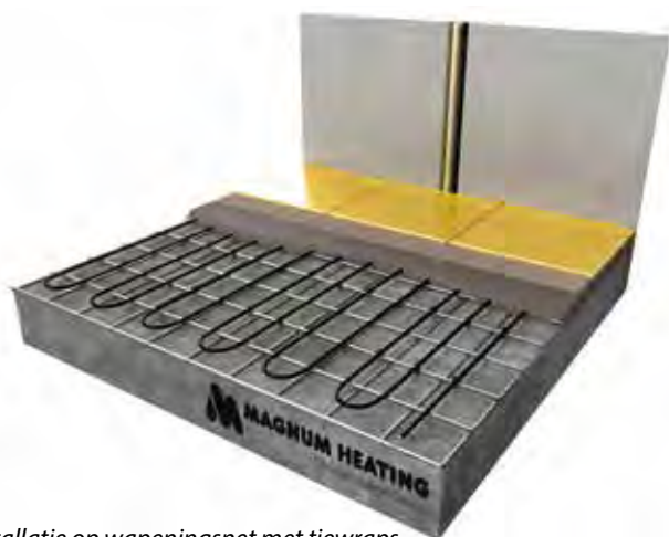
Installatie op wapeningsnet met tiewraps
