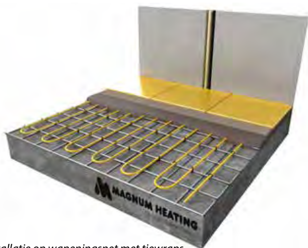
Installatie op wapeningsnet met tiewraps
