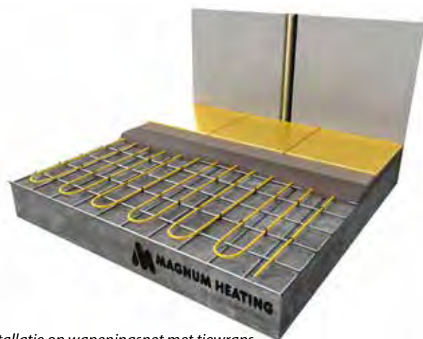
Installatie op wapeningsnet met tiewraps
