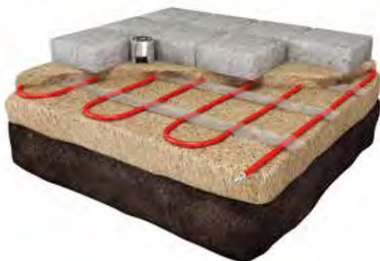
Installatie onder klinkers
